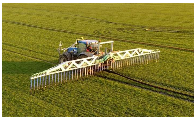
Figure 2 – Epandeur sans tonne munis d'un système de rampe et pendillards
